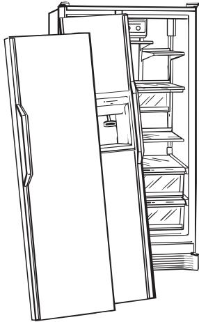
**Kjøleskapet må installeres av en godkjent installatør i henhold til disse installasjonsanvisningene.** Mål kjøleskapets døråpning, dybde og bredde. Fjern håndtak og dører hvis det er nødvendig. Installatøren må også gjøre følgende:
